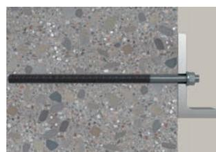
Injektionsmörtel FIS SB mit Bewehrungsanker FRA
