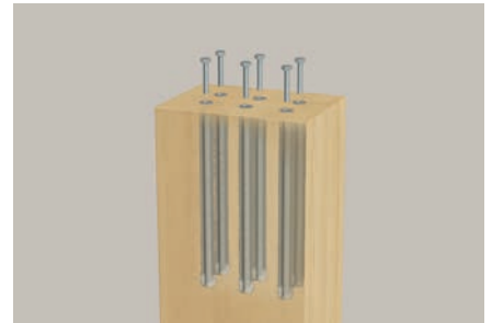
Verbindung mit Innengewindeanker FIS IG und Sechskantschraube
